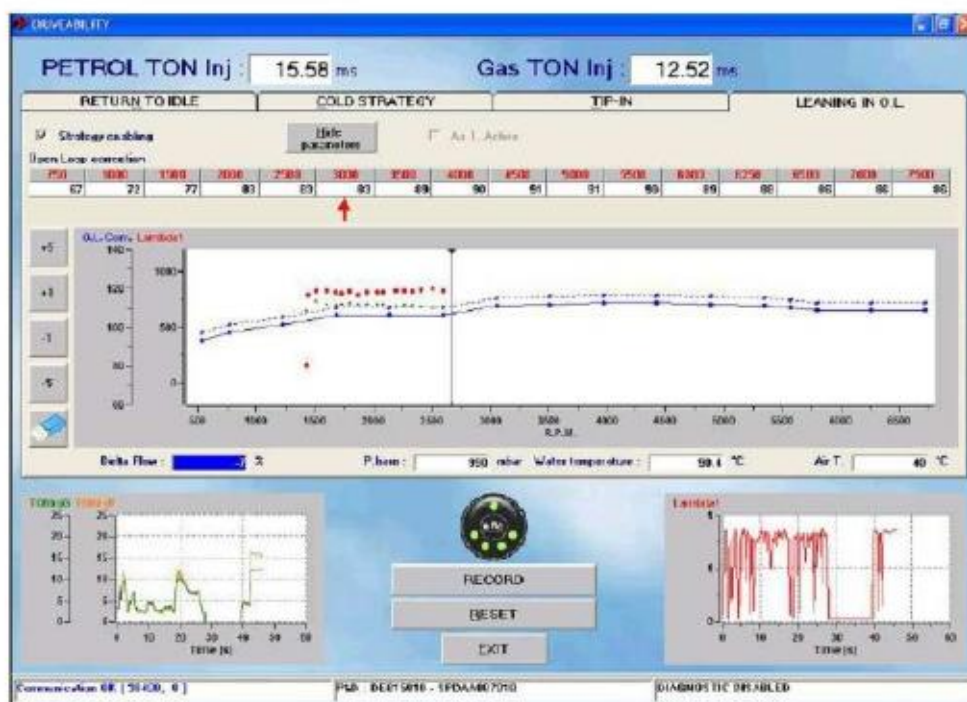
Фиг. 5-16 Настройки: управляемость — значение дельта-потока -7%
