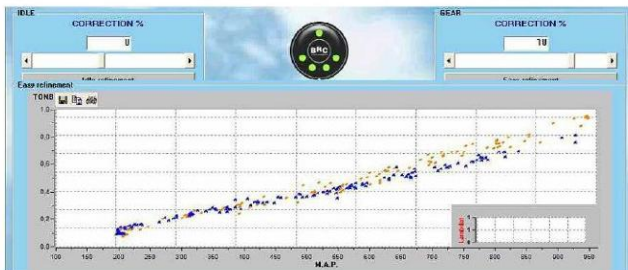
Фиг. 5-11 Коррекция «Нагрузка» (gear): значение +10%
